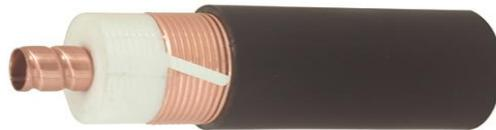
漏缆，漏泄同轴电缆的简称，集馈线传输和天线收发功能于一体，专用于对高铁、地铁隧道、矿井等狭长密闭空间，以及城区内人流密集写字楼、酒店、地下停车场等室分环境进行无线信号覆盖。
