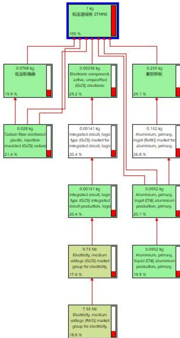
生命周期碳足迹结果网状结构图低压成套开关设备（ZTMNS）
